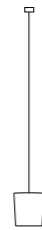
S1 MINI CANOPY Ceiling Rose Ø 40 mm H 15 mm Cable 3000 mm Diffuser Ø 135 mm H 150 mm
